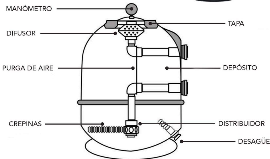
Velocidad Filtración: 50 m<sup>3</sup>/h/m<sup>2</sup>
