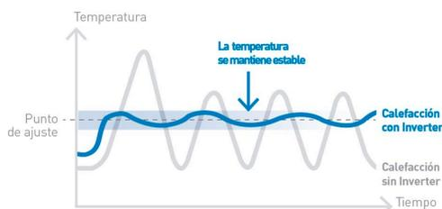
Ajusta la velocidad del compresor y el ventilador de forma inteligente para conseguir una óptima eficiencia.
